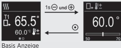
Die Einstellung kann mit den Tasten  $\oplus$  und  $\ominus$  in 1° Schritten verstellt werden und mit Taste  $\odot$  bestätigt werden. Die Änderung wird sofort im Display angezeigt und der Festwertregler arbeitet mit der neuen Einstellung.
