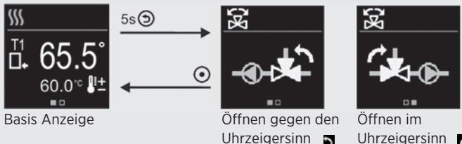
Die Einstellung kann mit den Tasten  $\oplus$  und  $\ominus$  verstellt werden und mit Taste  $\odot$  bestätigt werden.
