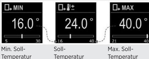
Einstellbereich der Temperaturen für min.-Temperatur = 5° C bis 30° C
