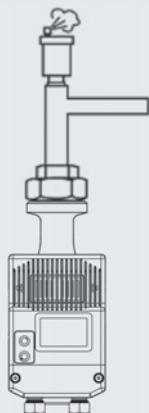
Należy prawidłowo napełnić i odpowietrzyć układ. W celu odpowietrzenia pompy należy uruchomić program odpowietrzający, patrz rozdział 7.6, sekcja IV.
