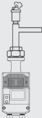
Anlage sachgerecht füllen und entlüften. Um die Pumpe zu entlüften, sollte das in Kapitel 7.3 Abschnitt IV beschriebene Entlüftungsprogramm durchlaufen werden. Nach diesem Vorgang kann die Pumpe in die gewünschte Regelungsart eingestellt werden.
