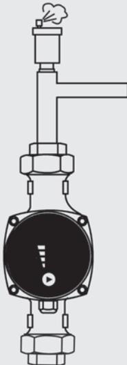
Llene y ventile el sistema correctamente. Para ventilar la bomba, se debe iniciar el programa de ventilación. (ver sección 11 en la página 76)
